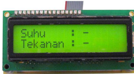
Gambar 11 Tampilan EMS LCD Display pada saat koneksi antar DT-I/O TCP/IP to UART Converter terputus
