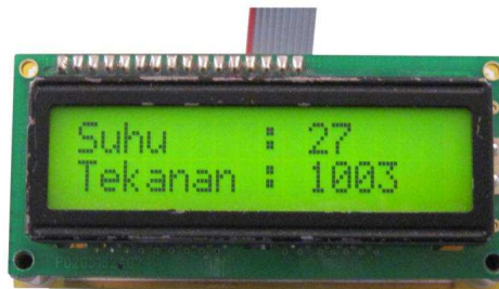
Gambar 10 Tampilan data suhu dan tekanan pada EMS LCD Display
